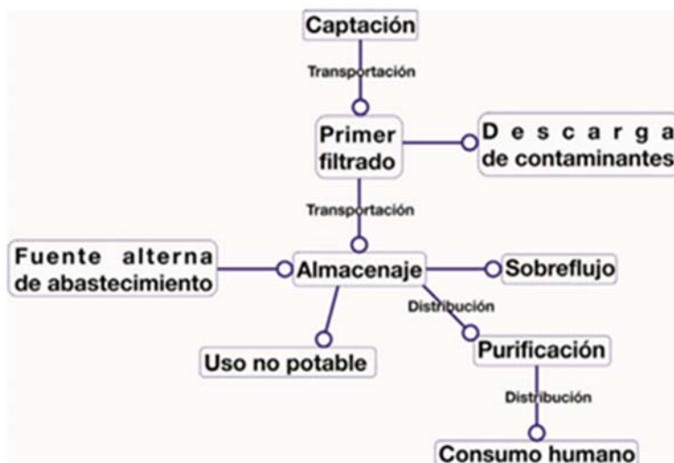
Figura 1 Diagrama de flujo de un sistema de captación de agua de lluvia
